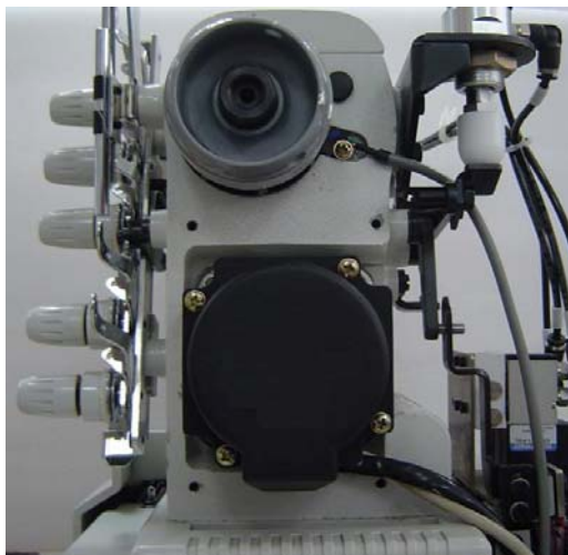
组图 3.1 ASU50 控制系统适配普通绷缝机电机下挂安装的示意图
