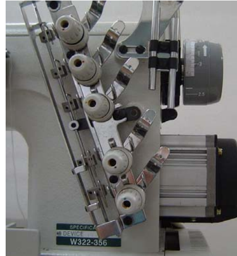
组图 3.1 ASU50 控制系统适配普通绷缝机电机下挂安装的示意图
