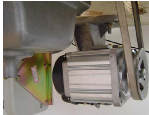
组图 3.1 ASU50 控制系统适配普通绷缝机电机下挂安装的示意图
