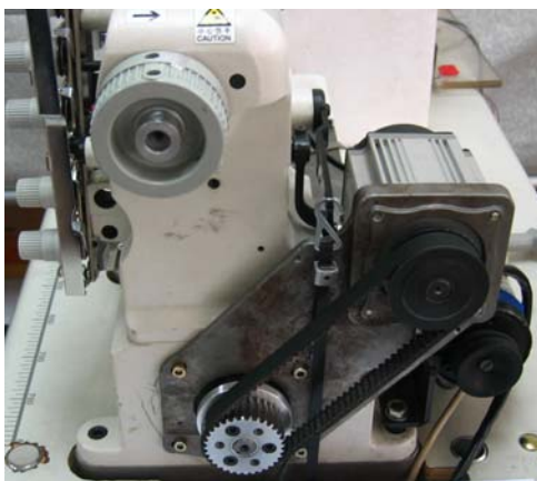
组图 3.3 ASB50 控制系统适配可背负电机的绷缝机安装示意图
